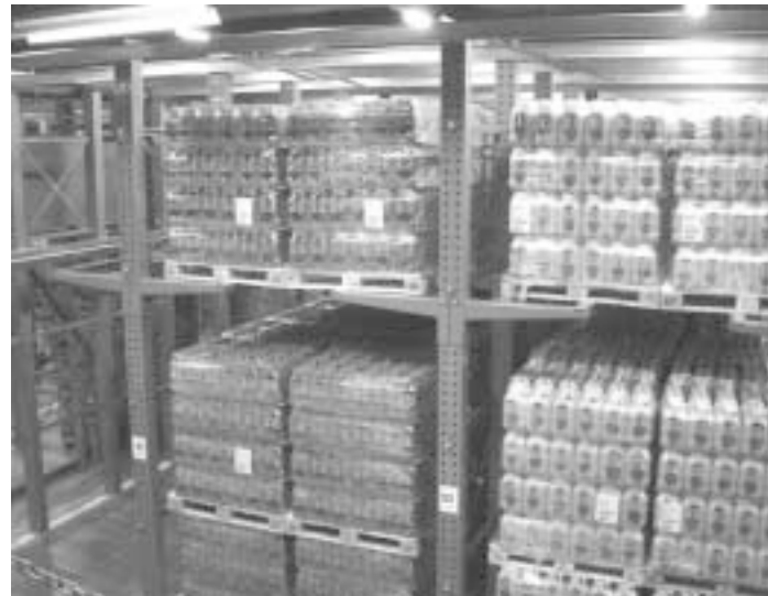
Regalsystem für die Getränkelagerung bei Doppelpaletten-Belegung
