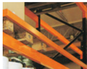
Durchschiebungssicherung verhindert das Durchschieben von Paletten
