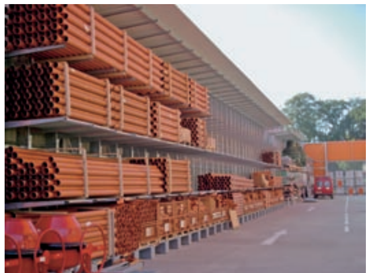
Image 2 : Stockage en extérieur sous auvent - les supports avec butées
