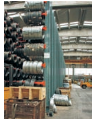
Image 2: Dans le rayonnage cantilever, les bobines de fil sont portées par un support de 2 mètres avec une capacité de charge de 1 tonne par support.
