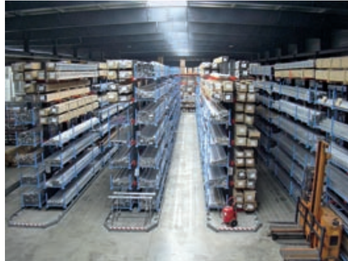
Image 1: Tubes dans des cassettes pour faciliter le conditionnement en vrac. Un rayonnage ELVEDI cantilever de plus de 9 m de haut pour des charges de 20 tonnes par casier et par face.
