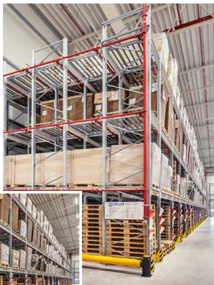
Ein rund 54 Meter breites Einschubregal ermöglicht die hochkompakte Lagerung von Verpackungen und Paletten.
