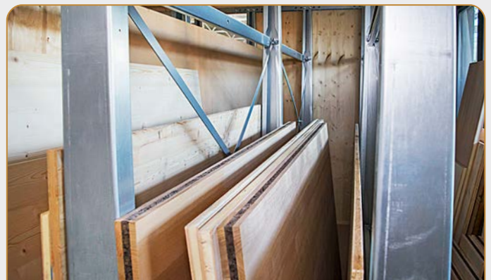
Verjüngte Fachteiler für eine schonende Lagerung
