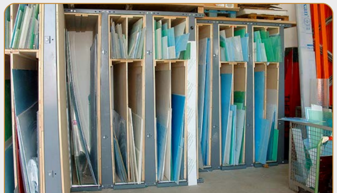
Einsatz eines vertikalen Plattenlagers in einer Schreinerei
