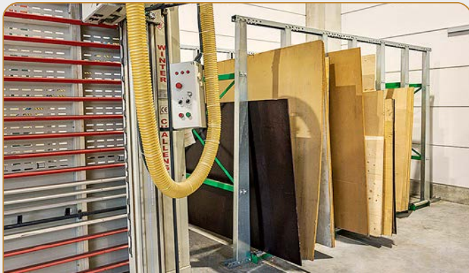
Traitement du bois dans un magasin spécialisé : scie avec râtelier de stockage pour les chutes
