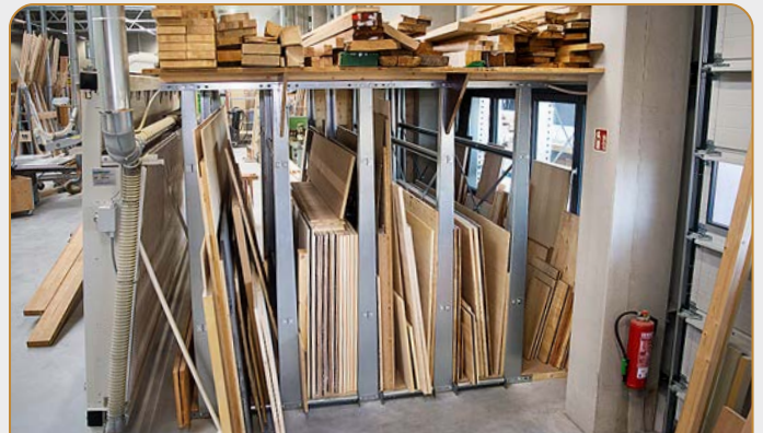
Surface supérieure utilisable comme surface de stockage supplémentaire (jusqu'à 340 kg/m 2 )
