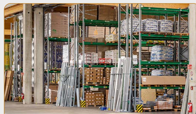
Extrémités de rayonnages complétées par des rayonnages verticaux VLS.
